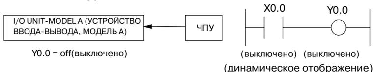
Если 1 принудительно вводится после установки OVERRIDE (ПЕРЕРЕГУЛИРОВАНИЕ) для Y0.0, то значение, измененное с помощью функции принудительного ввода-вывода, выводится на I/O UNIT-MODEL A (УСТРОЙСТВО ВВОДА-ВЫВОДА, МОДЕЛЬ A) как показано далее.
