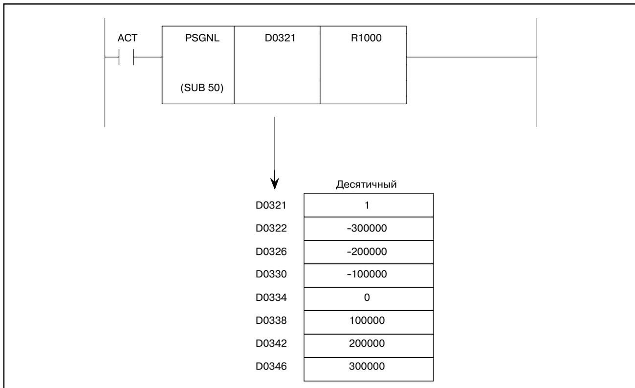
Если АСТ = 1 для указанной выше цепной схемы и данных спецификации разделения области, вывод области текущей спецификации (R1000) выглядит следующим образом:
