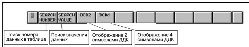
Дисплейные клавиши окна просмотра таблицы данных функциональной команды для функциональной команды CODB.
