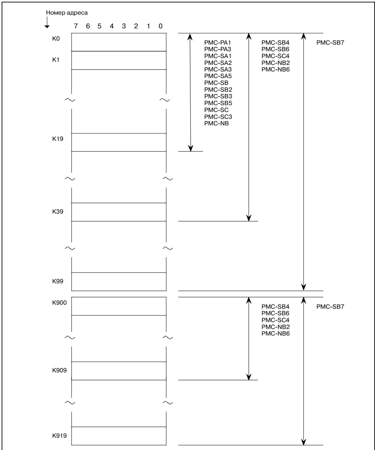
**Рис. 3.6 Адрес реле удержания и управление энергонезависимой памятью**
