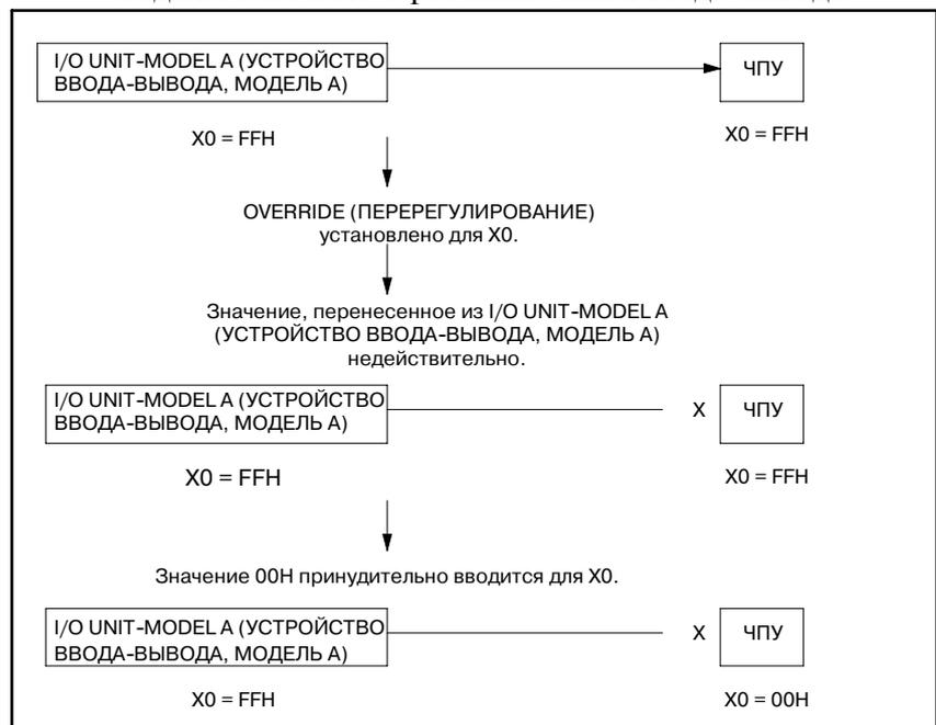
Поэтому можно использовать функцию принудительного ввода-вывода для адресов X в режиме OVERRIDE (ПЕРЕРЕГУЛИРОВАНИЕ) для отладки программы последовательности, если подключен станок.
