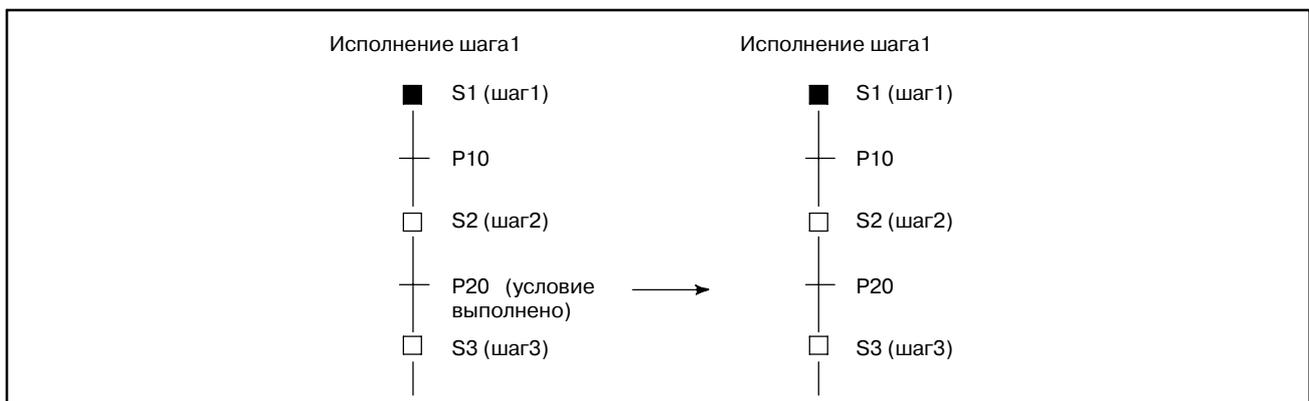
**Рис. 2.1 (d) Изменение состояния шага посредством передачи**
