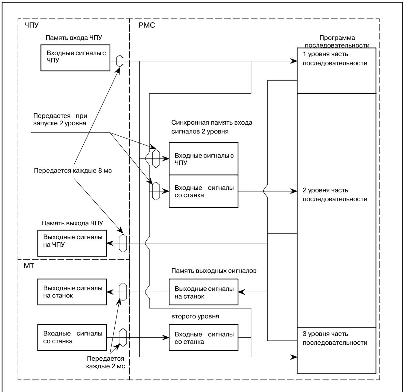
Рис. 2.5 Входные-выходные сигналы РМС
