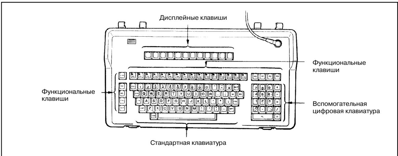
Рис. 3.3 (а) Панель клавиатуры SYSTEM P Mark II
