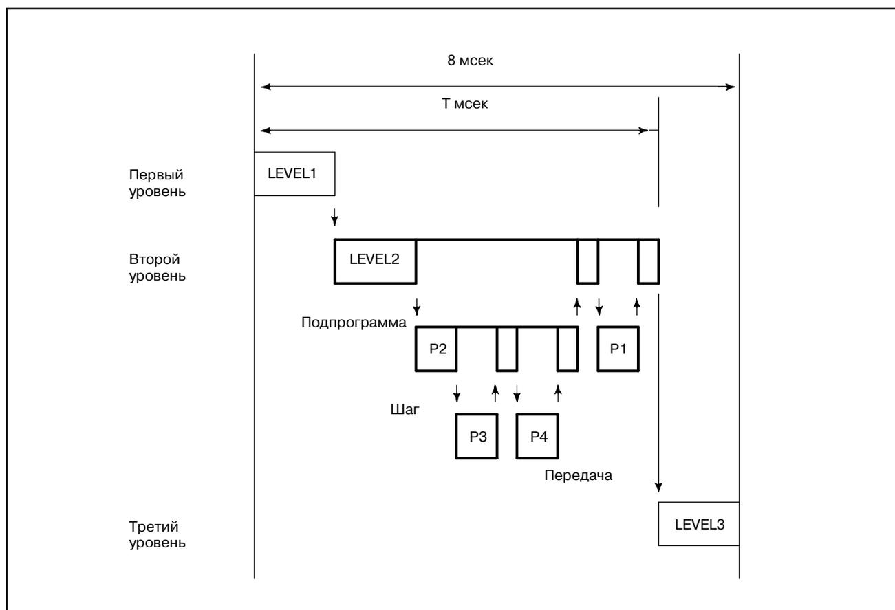
**Рис. 2.2 (d) Распределение времени исполнения программы пошаговой последовательности**
