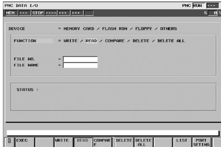
Если в меню DEVICE (УСТРОЙСТВО) выбрано "FLOPPY" (ГИБКИЙ ДИСК), разрешен вывод и ввод данных с гибкого диска или из файла типа handy, который подсоединяется через RS-232C.
