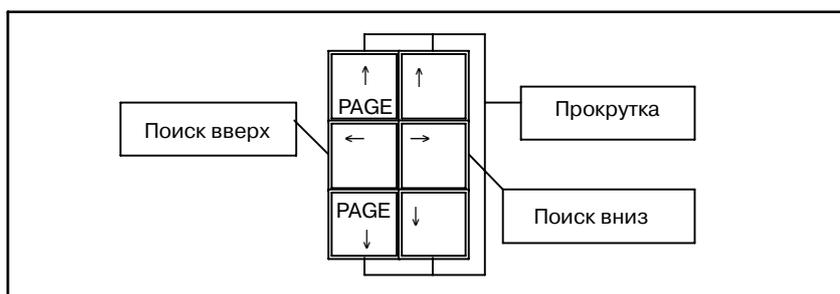
При отображенном курсоре вы можете перемещать курсор посредством клавиш перемещения курсора и клавиш смены страницы. Если курсор помещен на какое-либо реле или какой-либо параметр адреса функциональной команды, то информация об адресе отображается под курсором в "строке дополнительной информации".
