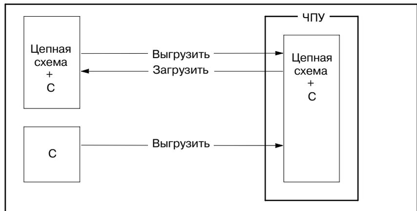
**Рис . 7.1.1 (а) Цепная схема и структура С для FANUC Серии 16В/16С**
