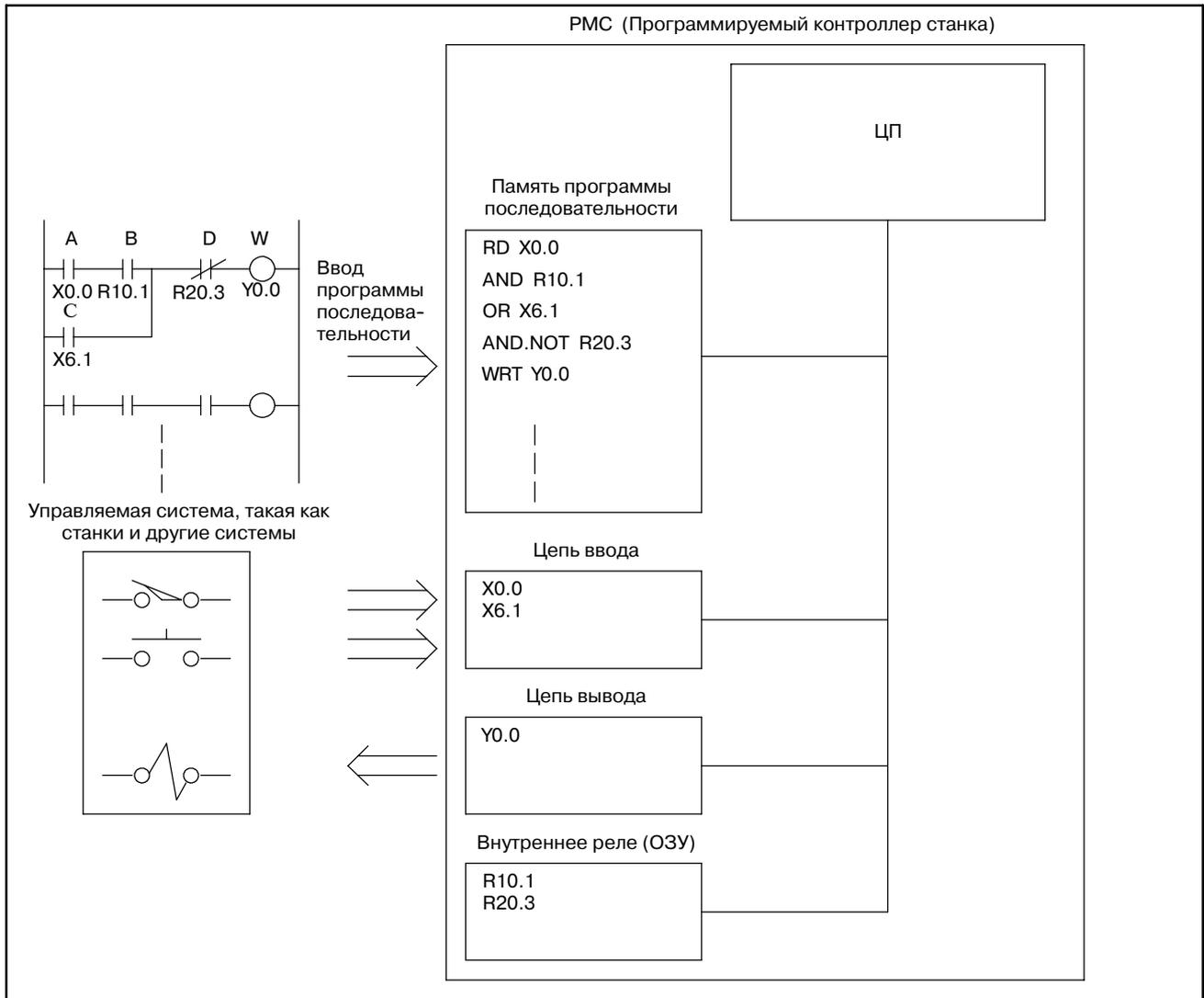
Рис. 1.3 Выполнение РМС программы последовательности
