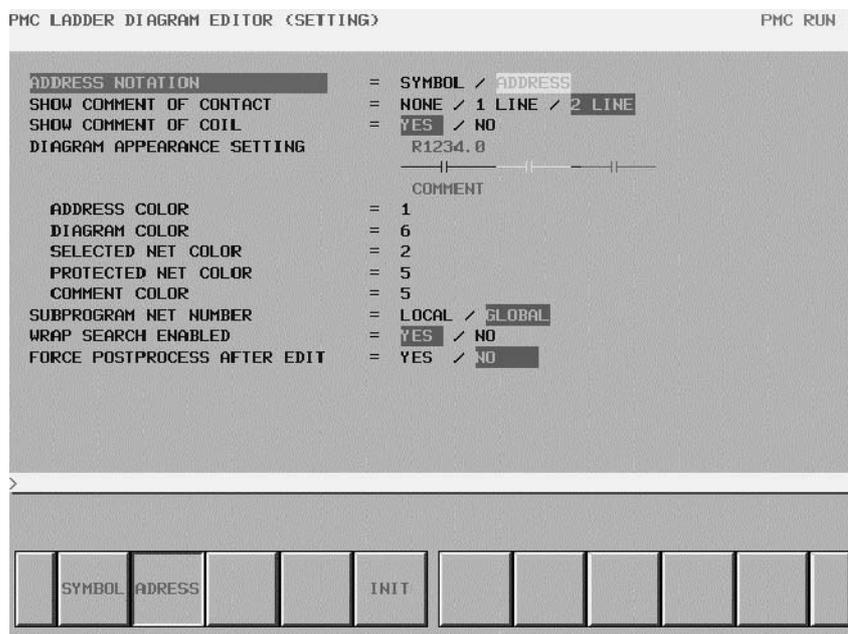
Рис . 5.4 Окно настройки редактирования диаграммы цепной схемы
