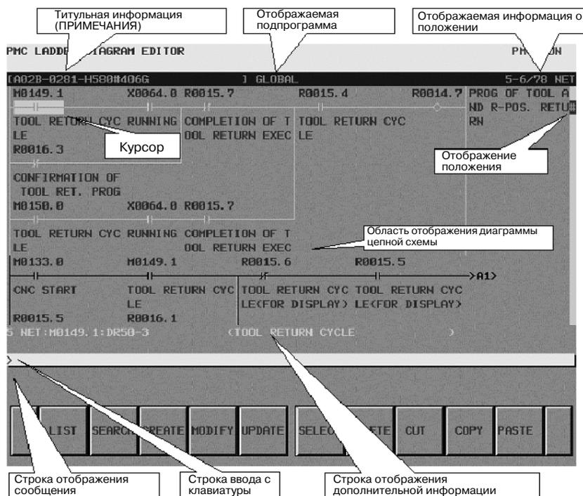
Рис . 5.2 Окно Редактирование диаграммы цепной схемы
