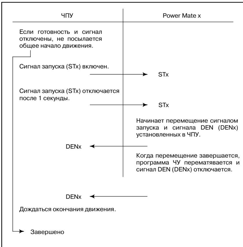
Интерфейс с блоками Power Mate изменяется на программу пошаговой последовательности.
