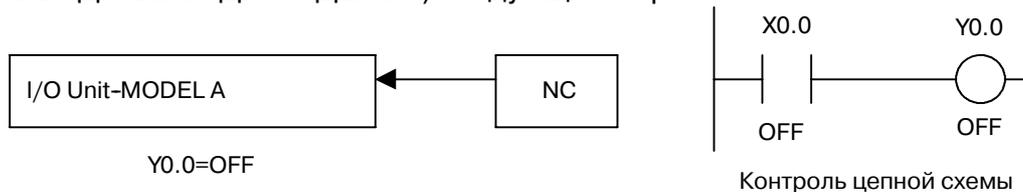
При установке "1" в Y0.0 в режиме перерегулирования, значение, которое выводится на I/O UNIT-MODEL A (БЛОК ВВОДА-ВЫВОДА МОДЕЛЬ А) будет следующим.
