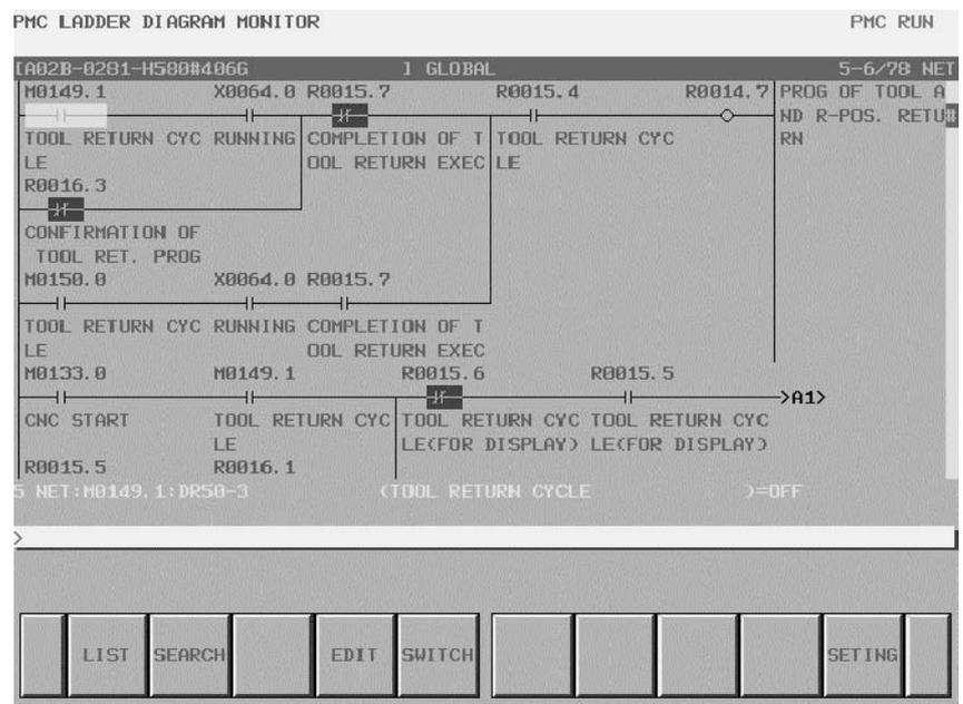
Рис . 4.1 (b) Окно Мониторинг диаграммы цепной схемы
