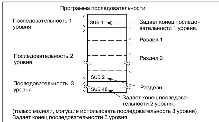
**Рис . 2.3 (а) Составление программы последовательности**
