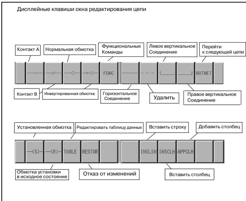
Рис . 5.5.2 (а) Дисплейные клавиши окна редактирования цепи
