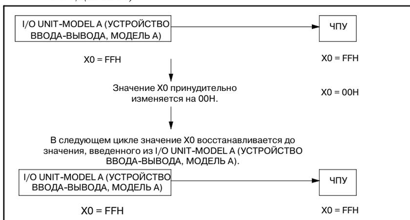
Циклическое перемещение может так же выполняться для неприсвоенных адресов. Поэтому используйте функцию принудительного ввода-вывода для X в режиме FORCING (ПРИНУДИТЕЛЬНЫЙ) для отладки программы последовательности, если нет подключенного или присвоенного станка. Используйте режим OVERRIDE (ПЕРЕРЕГУЛИРОВАНИЕ) для отладки программы последовательности в случае соединения ввода-вывода.
