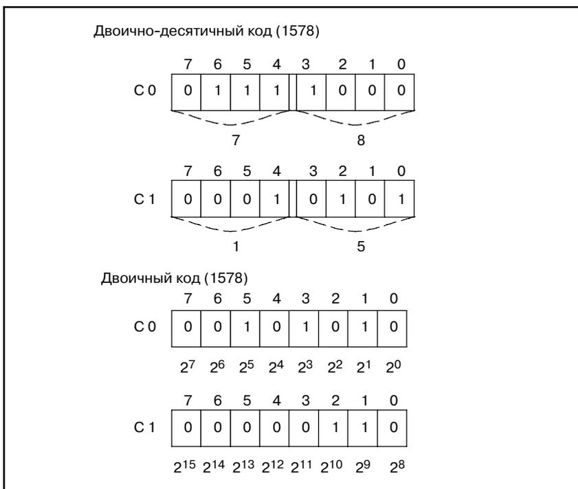
Чтобы изменить цифры низшего порядка заданного значения с помощью команды программы последовательности при использовании 1 байтовой обработки, задайте С0 в качестве адреса вывода параметров функциональных команд для ввода новых данных.
