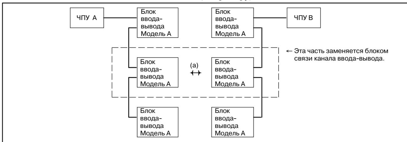
Следовательно, если используется блок связи канала ввода-вывода, соединения становятся такими, как показано ниже.
