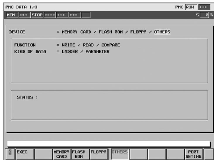
Если для DEVICE (УСТРОЙСТВО) выбран пункт "OTHERS" (ДРУГИЕ), возможен вывод и ввод с других устройств ввода-вывода.
