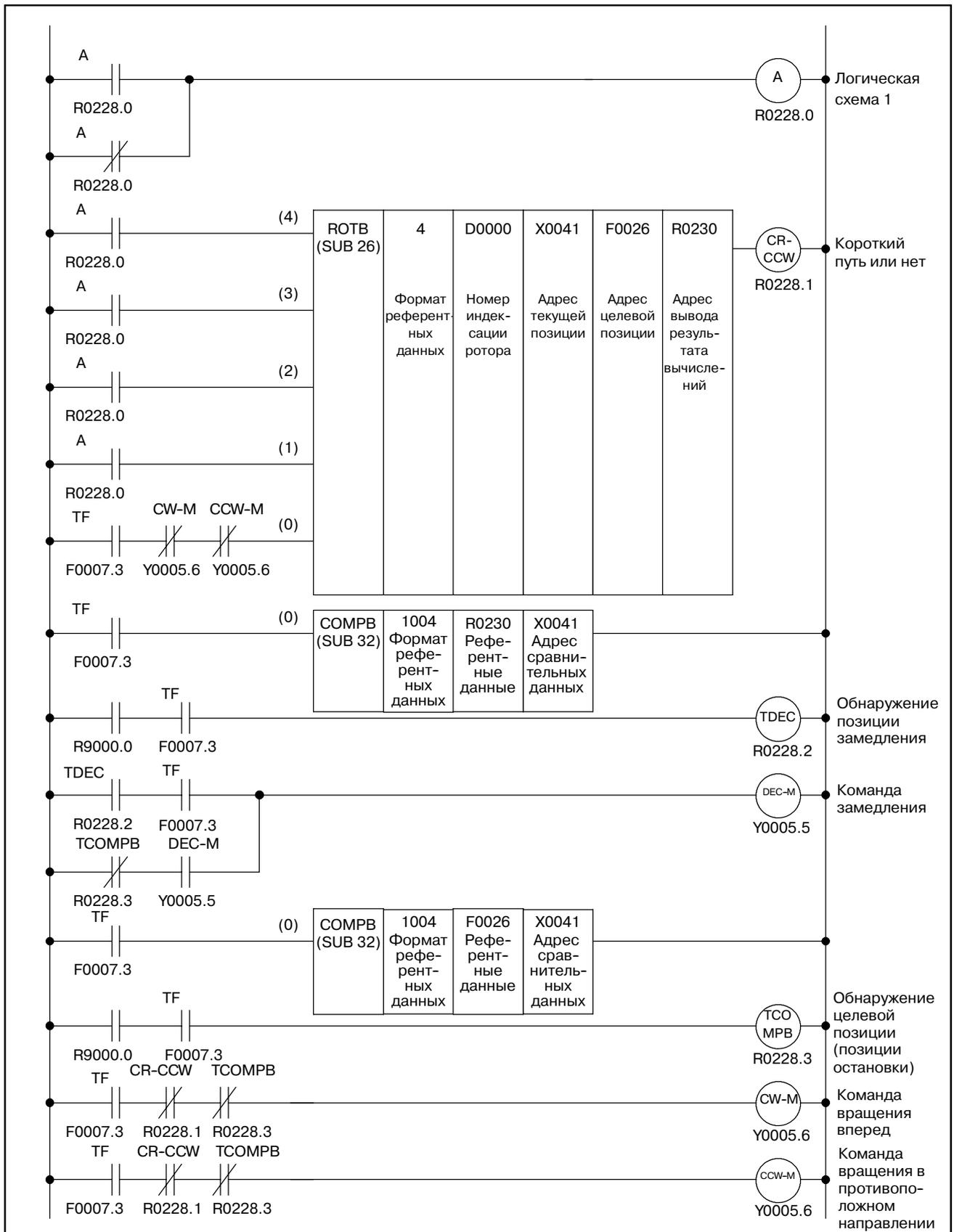
Рис. 5.13.6 Пример цепной схемы для команды ROTB
