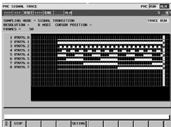
В режиме "SIGNAL TRANSITION" (ПРОХОЖДЕНИЕ СИГНАЛА) графическое отображение не обновляется до тех пор, пока какой-либо из сигналов для триггера выборочного контроля не изменится.
