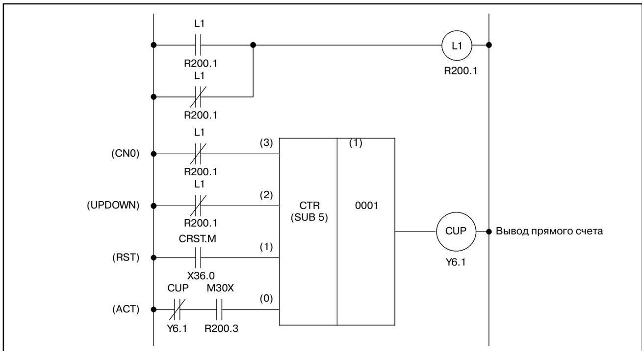
Рис. 5.9.6 (а) Цепная схема для счетчика, пример 1
