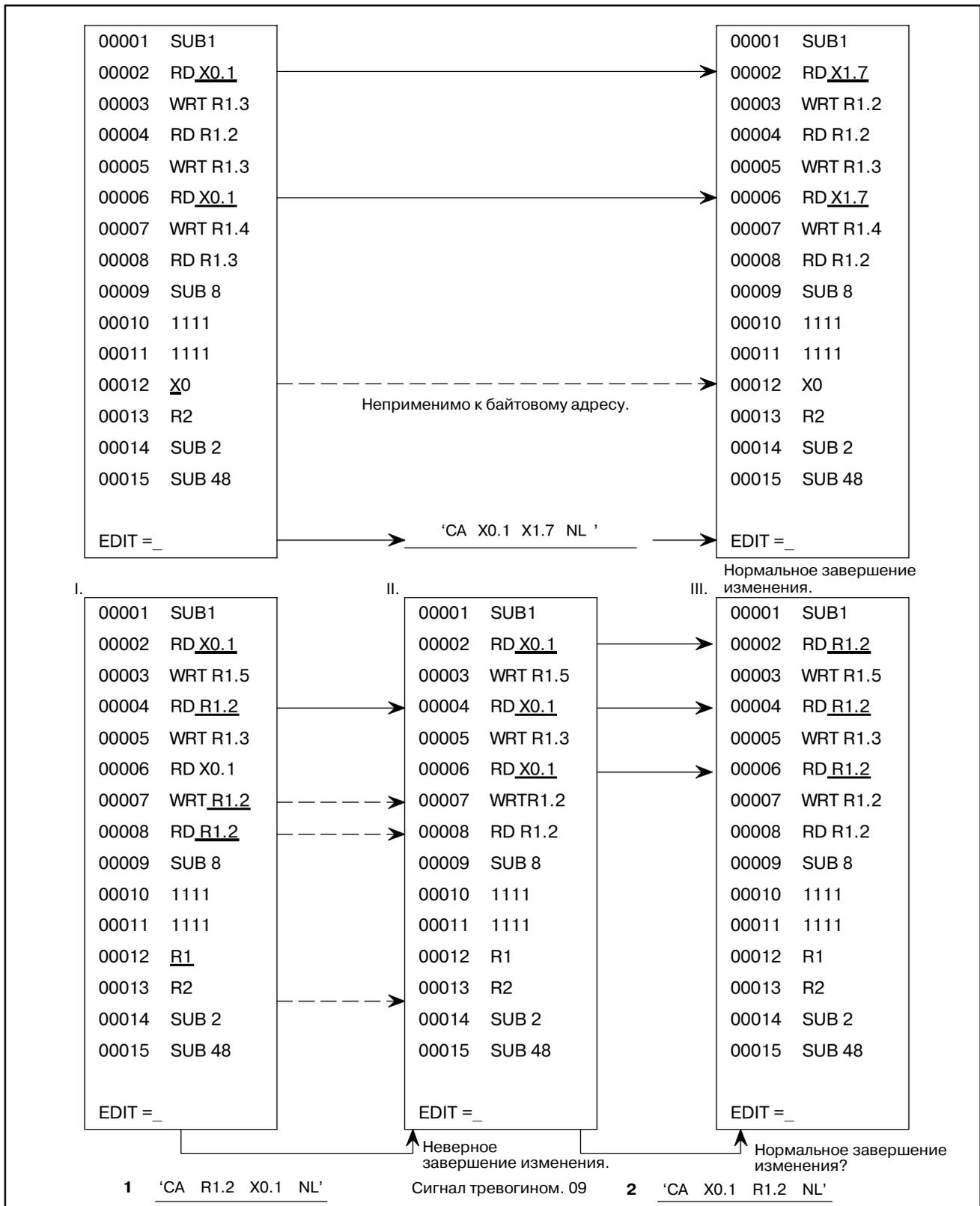
Как показано выше, сигнал тревоги ном. 09 срабатывает при изменении программы цепной схемы и при помощи операции 1 и будет выполняться программа цепной схемы ii. В таком случае, может быть невозможно осуществить возврат программы цепной схемы ii к программе цепной схемы i при помощи выполнения операции 2.
