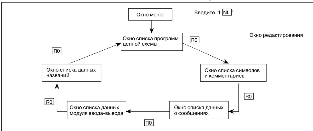
Рис. 4.3.1 (а) Последовательность переключения окна отображения данных
