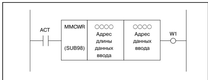
Рис . 5.49.2 Инструментальный формат MMCWR
