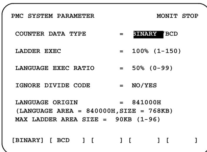
Рис . 4 (c) Экран системных параметров PMC- SC, SC3 или NB
