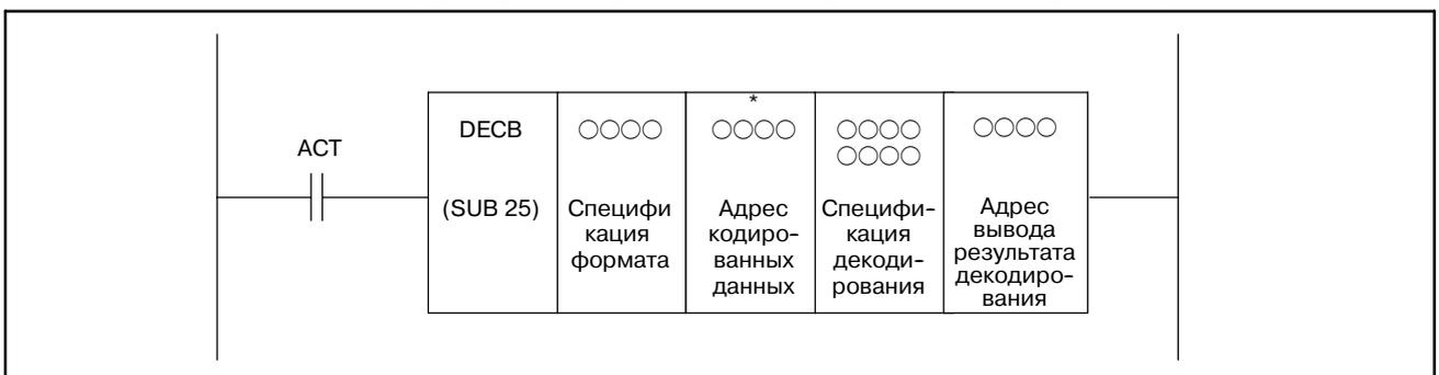
Рис. 5.8.2 (d) Формат выражения DECUB (расширенная спецификация) (только для PMC-SB5/SB6/SB7 для серии 16i/160i/18i/180i Power Mate i, PMC-SA5/SB6/SB7 для серии 21i/210i, PMC-SB7 для серии 0i-B и PMC-NB6 для серии 15i)
