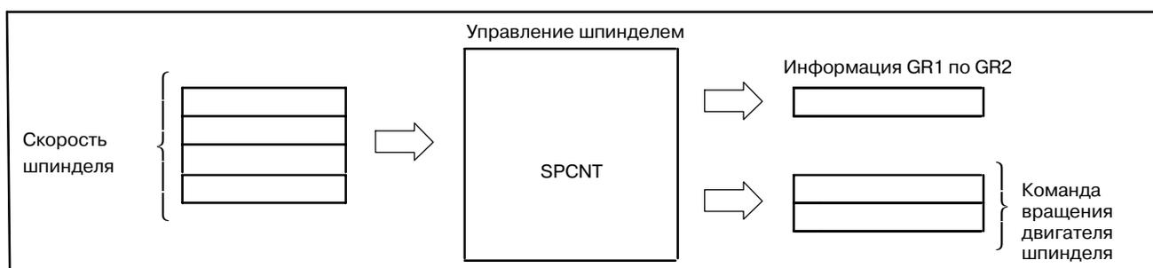
Скорость двигателя шпинделя может быть зафиксирована на верхнем и нижнем пределе так же с помощью прямой спецификации передачи. Если ЧПУ выполняет контроль постоянной скорости по поверхности, то обычно выполняется управление шпинделем с прямой спецификацией передачи.
