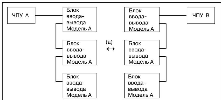
Блок связи канала ввода-вывода заменяет эти блоки ввода-вывода, таким образом устраняя необходимость соединять их, к примеру, кабелями.
