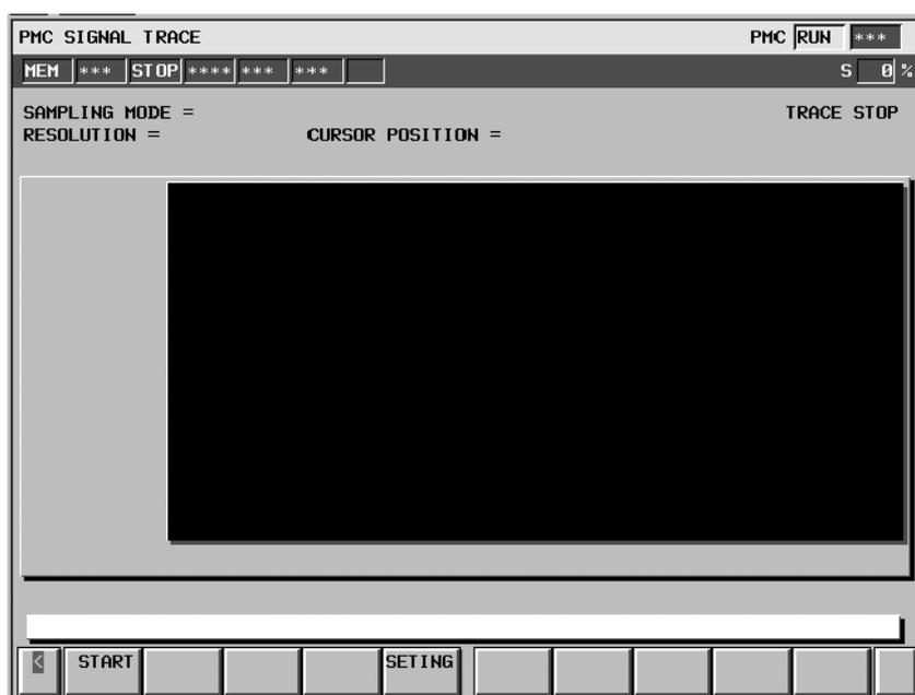
Для того, чтобы выполнить трассировку, необходима установка параметров трассировки. Нажатие дисплейной клавиши [SETTING] (УСТАНОВКА) отображает окно "Parameter Setting" (Установка параметров). Функция трассировки может запускаться автоматически при определенной установке в окне "PMC Setting" (Настройка РМС) при включении питания. В этом случае необходима предварительная установка параметра трассировки.
