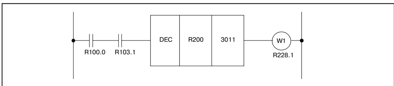
Рис. 5.7.6 Диаграмма цепной схемы с использованием команды DEC
