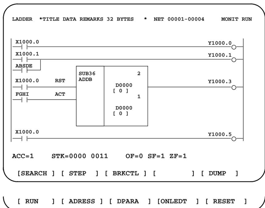
Рис . 8.4.1 Окно функции отладки цепной схемы
