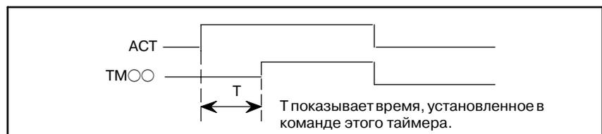
Рис. 5.4.4 (b) Работа таймера
