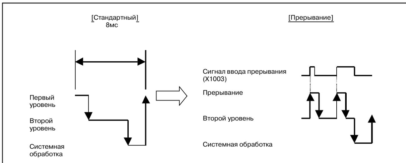
Рис. 11.1 Порядок выполнения программы последовательности
