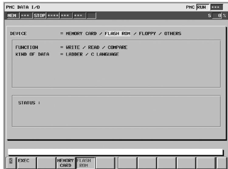
Если в качестве DEVICE (УСТРОЙСТВО) выбран пункт "FLASH ROM" (ФЛЭШ-ПЗУ), то возможен вывод и ввод с флэш-ПЗУ.
