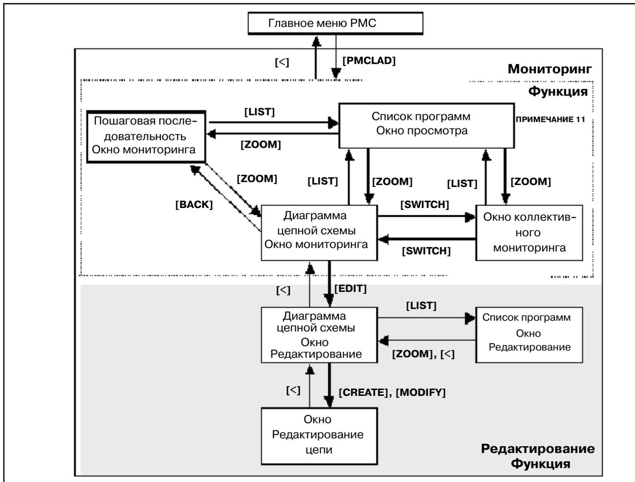
Рис . 3 Связь окон мониторинга и редактирования
