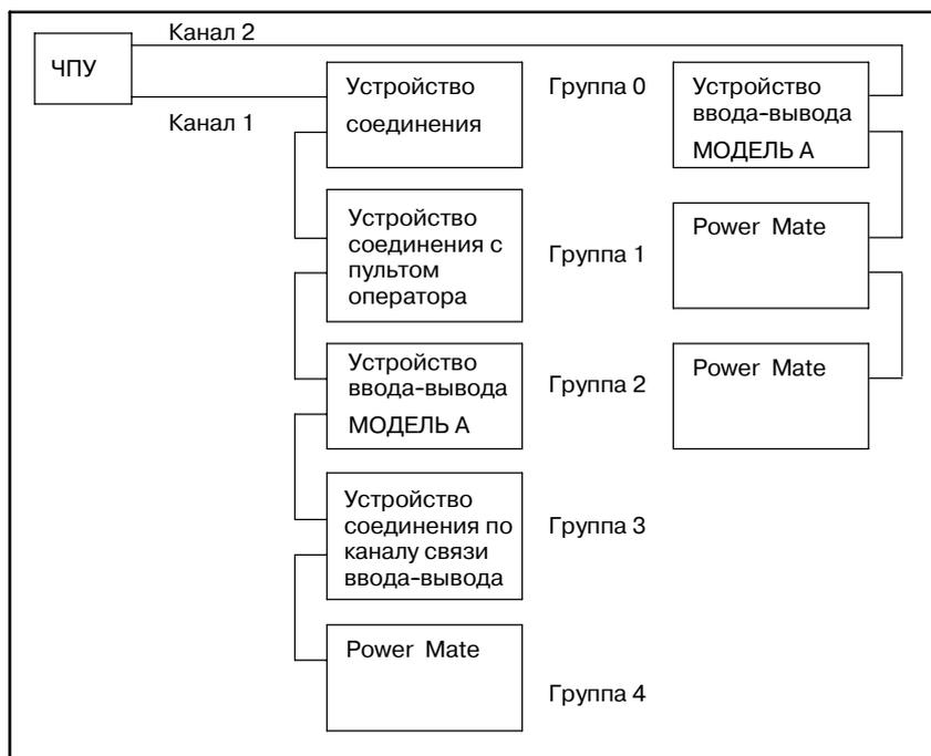
**Рис . 3.8.1 (d) Конфигурация канала связи ввода-вывода**
