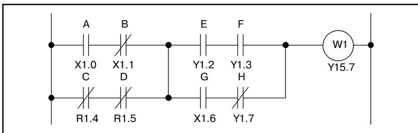
Рис . 4.1.10 Цепная схема
