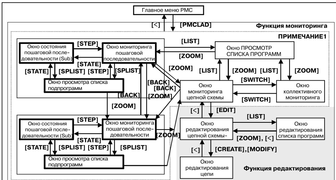
Рис. 7.1 Связь окон мониторинга и редактирования
