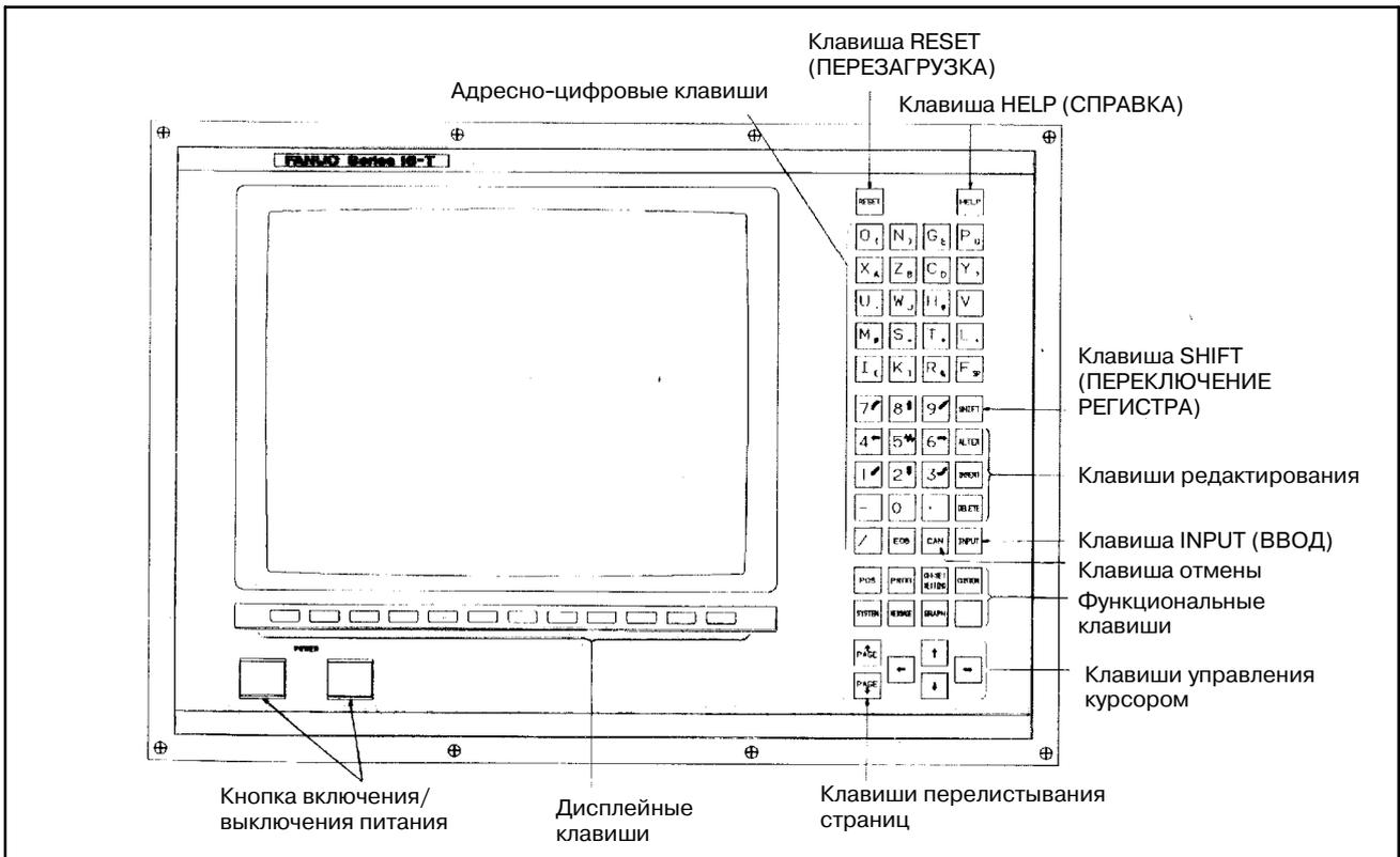
ф) 14" цветной ЭЛТ-монитор/панель ручного ввода данных для 16-ТА/18-ТА (Вертикальный тип)
