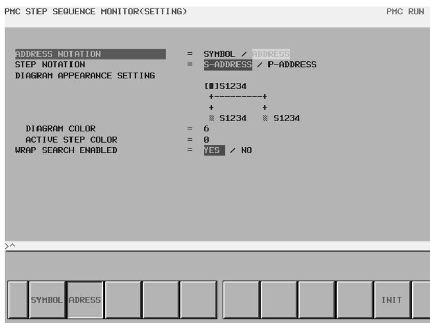
Рис . 7.1.3.3 Окно настройки мониторинга пошаговой последовательности
