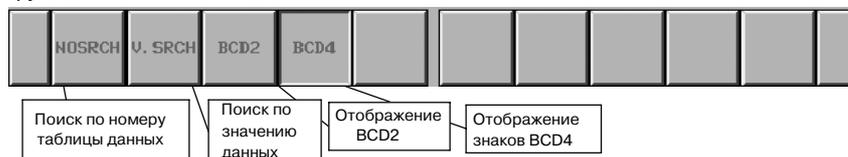
Дисплейные клавиши окна просмотра таблицы данных функциональных команд функциональной команды CODB.
