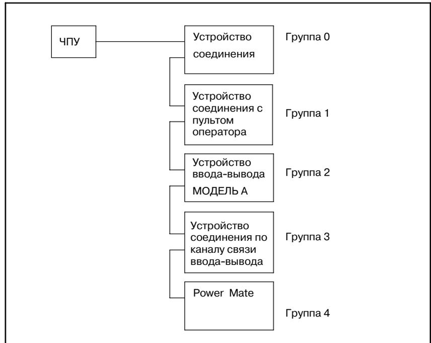
**Рис . 3.8.1 (b) Конфигурация канала связи ввода-вывода**
