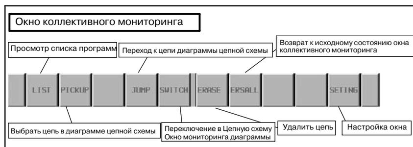
**Рис . 4.3 (а) Дисплейные клавиши окна коллективного мониторинга**
