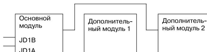
Невозможно присвоить модуль расширения 2 без модуля расширения 1, который будет установлен позже, как показано выше.
