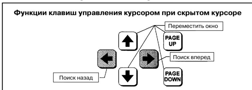
Если курсор отображен, то его можно перемещать при помощи любой из клавиш управления курсором или клавиш перелистывания страниц. Если курсор находится на одном из реле или на одном из адресных параметров функциональной команды, то информация, относящаяся к адресу под курсором, отображается в строке дополнительной информации.
