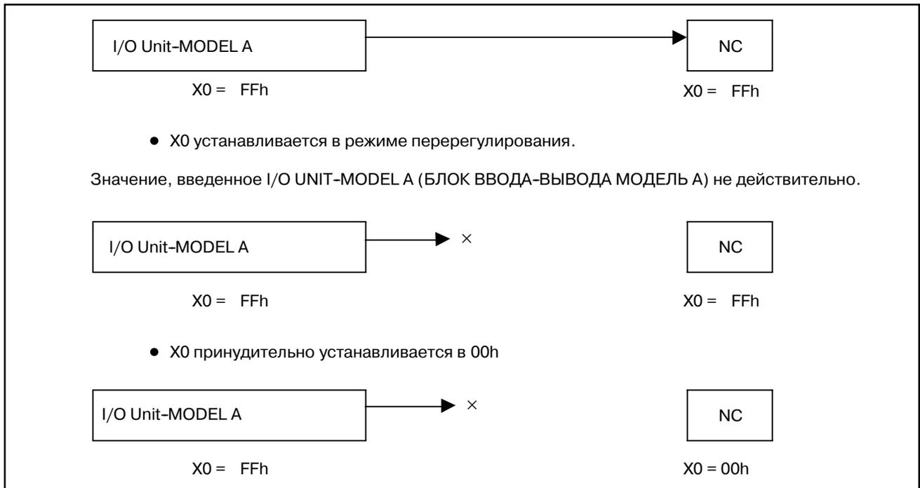
Поэтому функция принудительного ввода-вывода для X адресов в режиме перерегулирования может использоваться для отладки программы цепной схемы при наличии нескольких устройств ввода-вывода. При установке режима перерегулирования в адреса Y, значение, которое принудительно меняется, выводится на устройства ввода-вывода.
