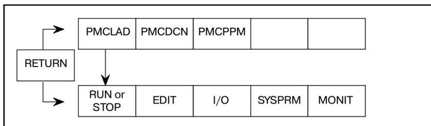
**Рис . 6.1 Дисплейная клавиша исполнения программы последовательности**
