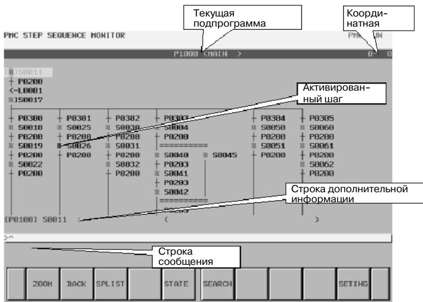
**Рис . 7.1.3.1 Окно мониторинга пошаговой последовательности**
