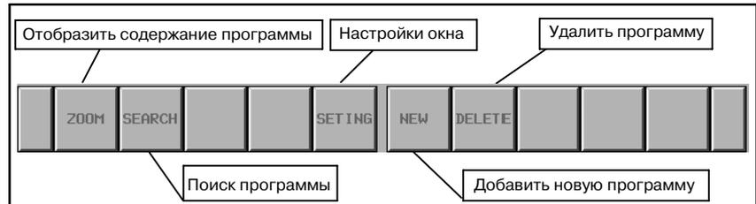
**Рис . 5.9.1 Дисплейные клавиши окна Редактирование списка программ**
