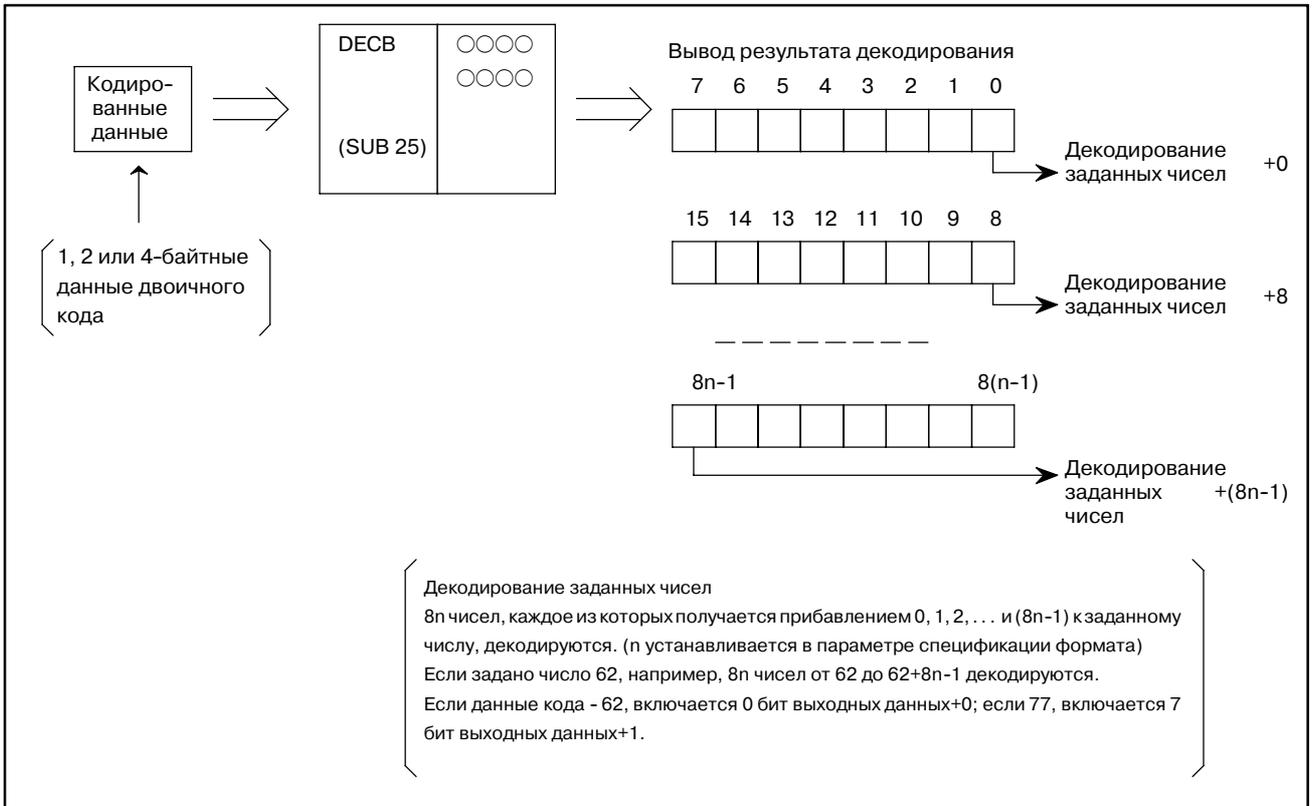
Рис. 5.8.2 (b) Функция DECUB (расширенная спецификация) (только для PMC-SB5/SB6/SB7 для серии 16i/160i/18i/180i Power Mate i, PMC-SA5/SB6/SB7 для серии 21i/210i, PMC-SB7 для серии 0i-B и PMC-NB6 для серии 15i)
