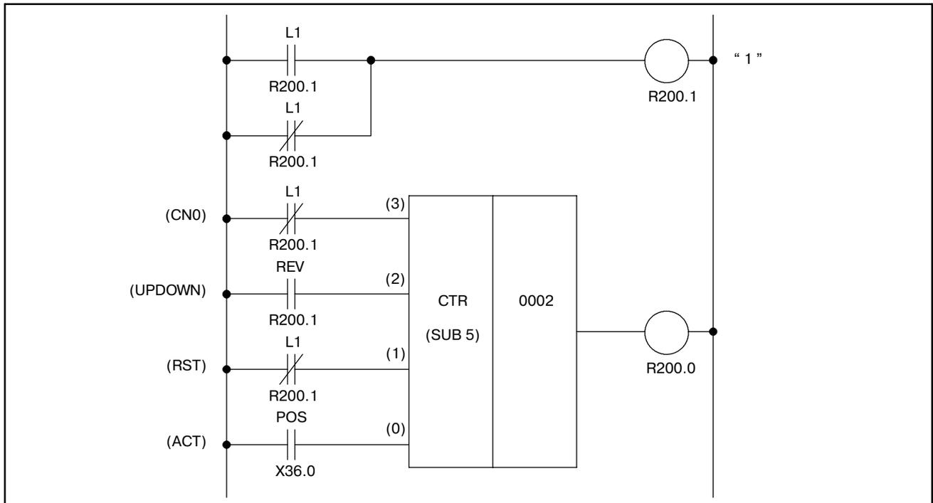
**Рис. 5.9.6 (b) Цепная схема для счетчика, пример 2**
