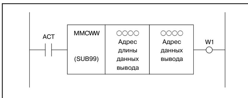
Рис . 5.50.2 Инструментальный формат ММСWW
