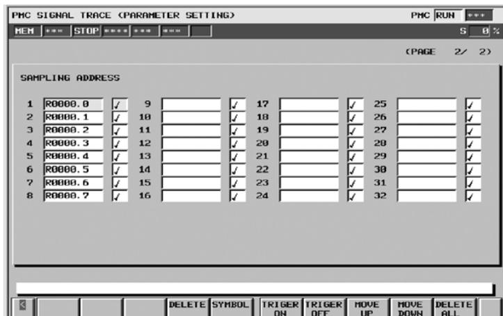
Ввод сигналов от бита 0 до бита 7 в "SAMPLING ADDRESS"(АДРЕС ВЫБОРОЧНОГО КОНТРОЛЯ) представляет собой установку, аналогичную вводу адреса в байтах для PMC-NB/NB2. Установка триггера сигналов выборочного контроля - аналогична набору данных маски ("MASK DATA")(ДАННЫЕ МАСКИ) для PMC-NB/NB2.
