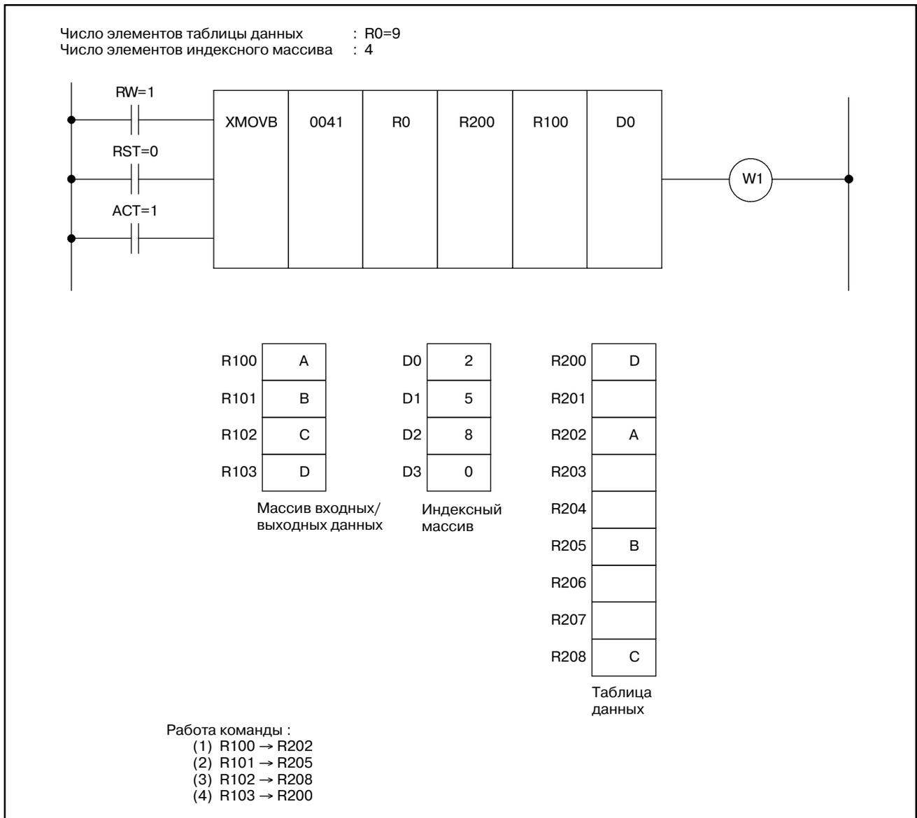
**Рис. 5.32.6 (b) Пример XMOVB (расширенная спецификация) (только для PMC-SB5/SB6/SB7 для серии 16i/160i/18i/180i Power Mate i, PMC-SA5/SB6/SB7 для серии 21i/210i, PMC-SB7 для серии 0i-B и PMC-NB6 для серии 15i)**
