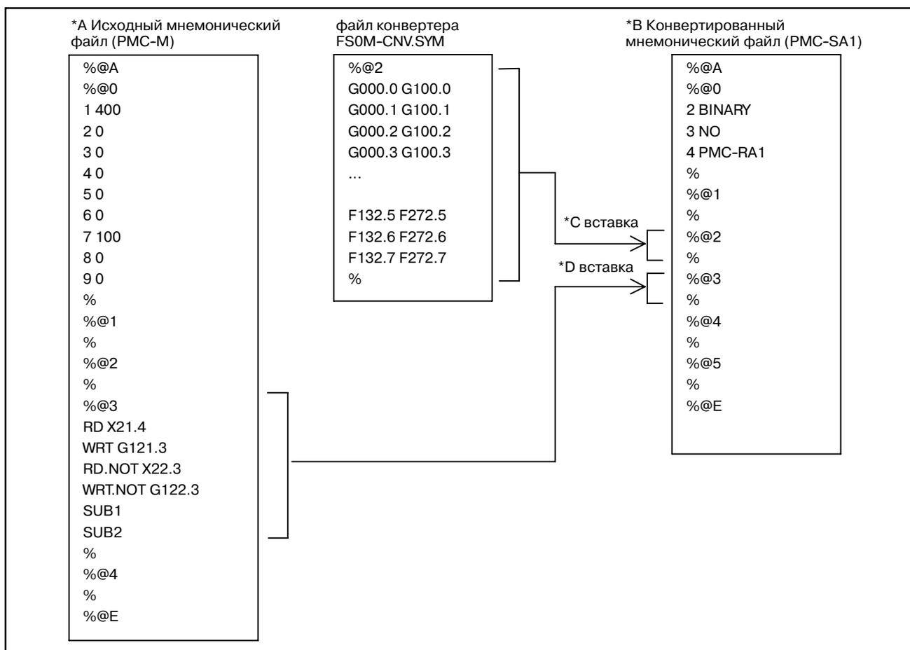
При использовании FANUC LADDER-II (Пример: Конвертирование цепной схемы на PMC-SA3 для Серии 0i-TA с PMC-M для Серии 0T)
