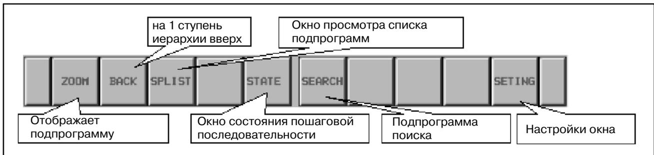
Рис. 7.1.3.2 Дисплейные клавиши окна мониторинга пошаговой последовательности
