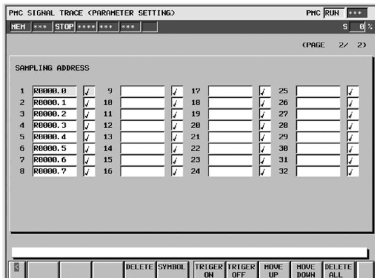
Нажатие дисплейной клавиши [TRIGGER ON] устанавливает триггер в положение "включен". Нажатие дисплейной клавиши [TRIGGER OFF] устанавливает триггер в положение "выключен". Установка по умолчанию соответствует триггеру в положении "включен" для всех сигналов. Содержание других дисплейных клавиш будет совпадать с "SAMPLING ADDRESS" (АДРЕС ВЫБОРОЧНОГО КОНТРОЛЯ).
