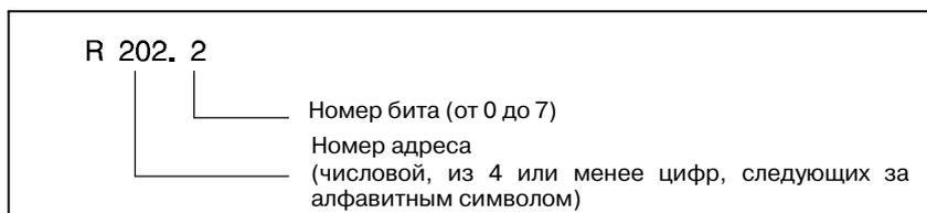
В начале каждого номера адреса ставится алфавитный символ для обозначения типов сигналов как показано в Таблице 7.1.1.
