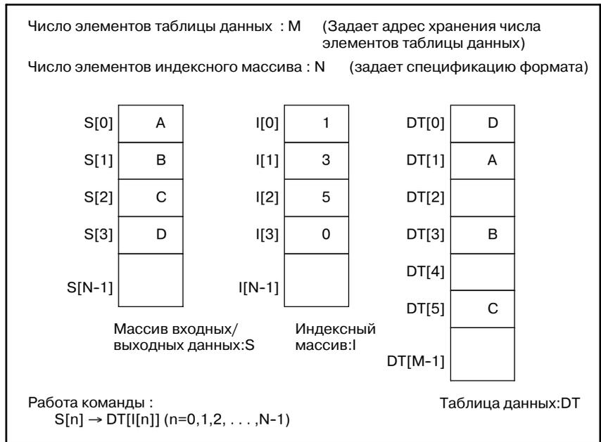
**Рис . 5.32.1 (d) Запись данных в таблицу данных (расширенная спецификация) (только для PMC-SB5/SB6/SB7 для серии 16i/160i/18i/180i Power Mate i, PMC-SA5/SB6/SB7 для серии 21i/210i, PMC-SB7 для серии 0i-B и PMC-NB6 для серии 15i)**
