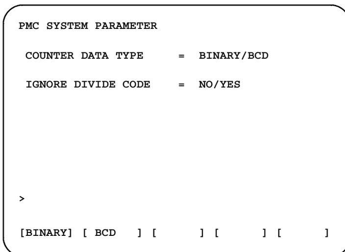
Рис . 4 (b) Экран системных параметров, серия PMC-SB
