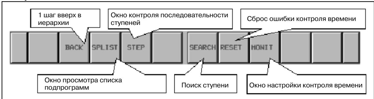
**Рис. 7.2.2.1** Дисплейные клавиши окна состояния последовательности ступеней (подпрограмма)
