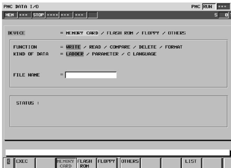
В этом окне программу последовательности, параметры PMC и программу на языке C можно записать на заданное устройство, считать с устройства и сравнить. Курсор выделения пункта, который перемещается вертикально от одного пункта к другому, отображается так же, как и курсор выделения опций, который перемещается горизонтально от одной опции к другой. Отображаемые дисплейные клавиши меняются в зависимости от положения курсора выделения пункта.
