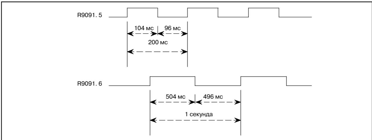
(7) Сигнал прохождения RUN до STOP, Сигнал прохождения STOP до RUN и сигнал статуса RUN (PMC-SB7)
