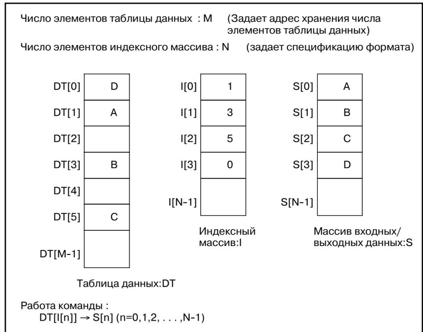
**Рис . 5.32.1 (b) Чтение данных из таблицы данных (расширенная спецификация) (только для PMC-SB5/SB6/SB7 для серии 16i/160i/18i/180i Power Mate i, PMC-SA5/SB6/SB7 для серии 21i/210i, PMC-SB7 для серии 0i-B и PMC-NB6 для серии 15i)**
