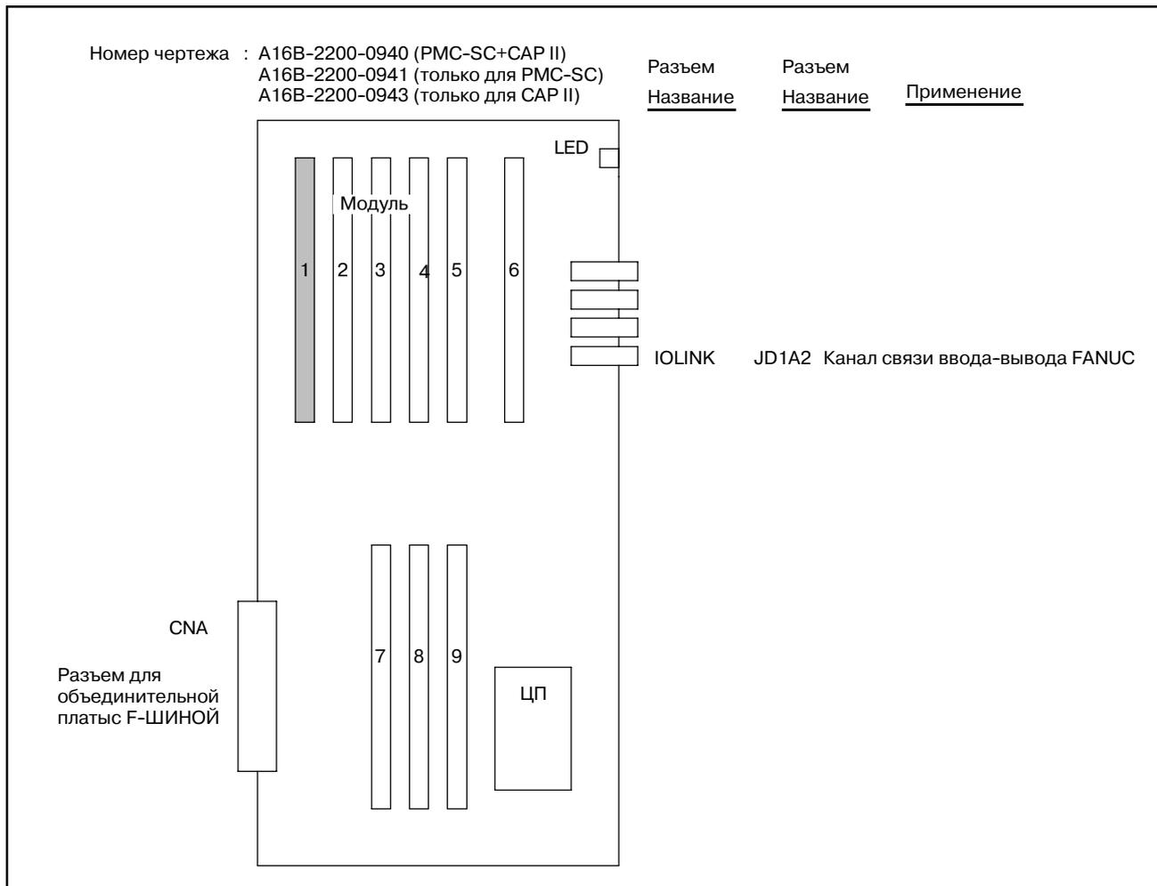
Рис. 2.1 (b) Расположение частей на дополнительной плате 3 (Серия 16)
