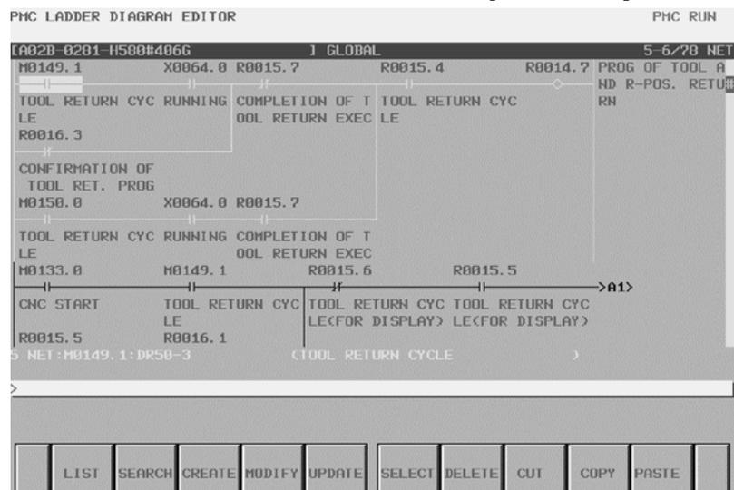
Рис . 5.1 Окно Редактирование диаграммы цепной схемы
