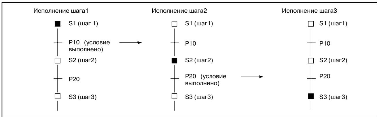
**Рис. 2.1 (с) Изменение состояния шага посредством передачи**
