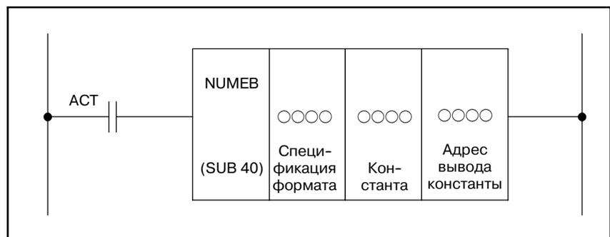
Рис . 5.42.2 (б) Формат выражения NUMEB (расширенная спецификация) (только для PMC-SA5/SB5/SB6/SB7 для серии 16*i*/160*i*/18*i*/180*i*/21*i*/210*i*; Power Mate *i*, PMC-SB7 для серии 0*i*-В и PMC-NB6 для серии 15*i*/150*i*)
