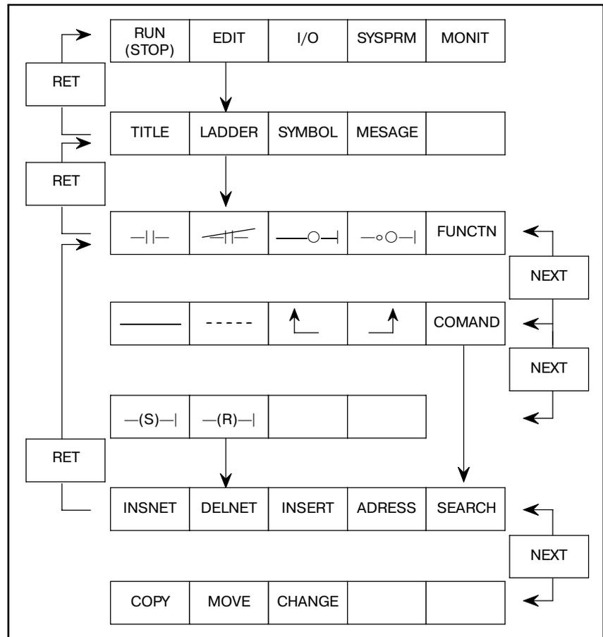
Рис . 5.2 Дисплейные клавиши генерирования программы последовательности
