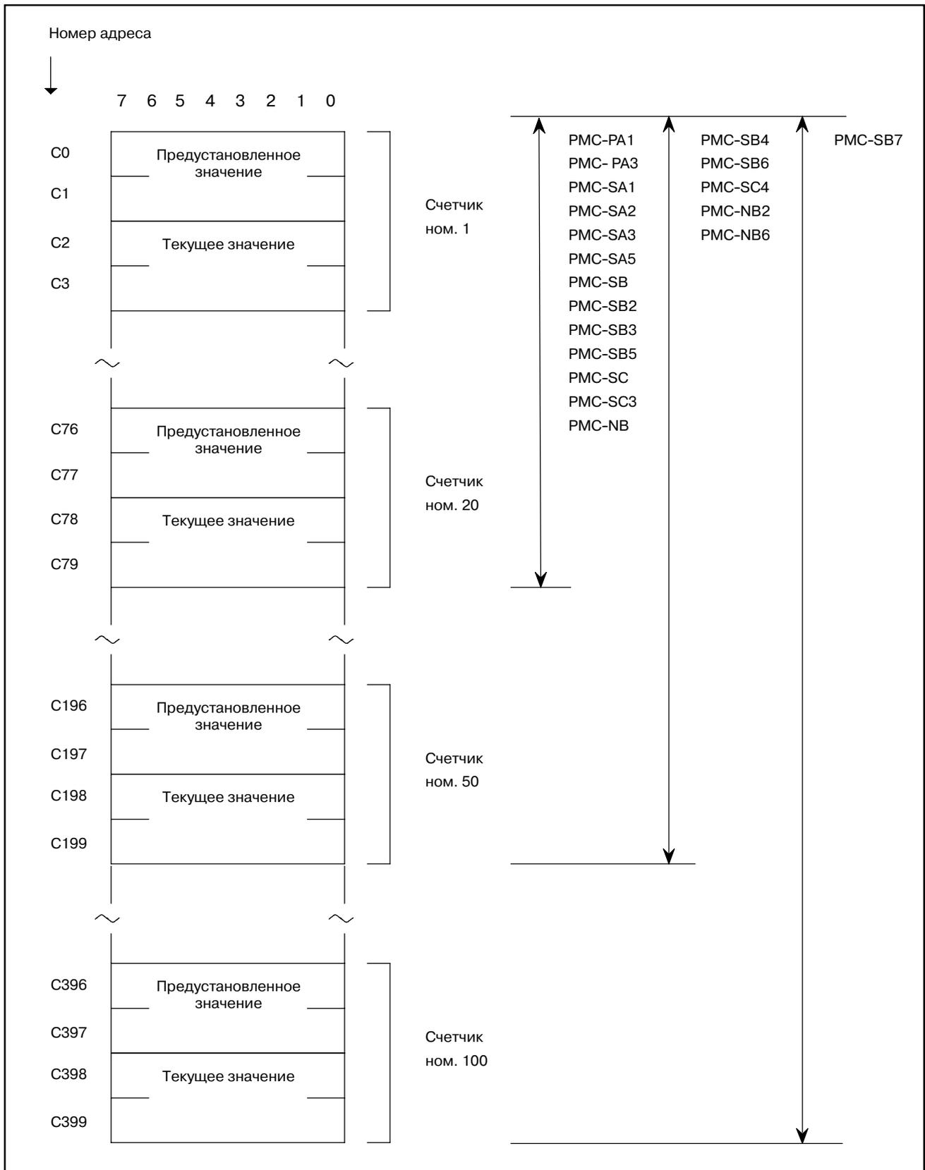
Рис. 3.5 Адрес счетчика
