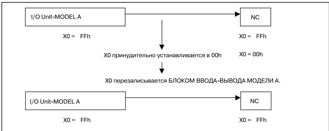
Передача в цикле может выполняться по адресам, которым не присвоено ни одно из устройств ввода-вывода. Таким образом, следует использовать функцию принудительного ввода-вывода в принудительном режиме при отсутствии устройств ввода-вывода для отладки какого-либо из X адресов. Для отладки программы цепной схемы при наличии устройств ввода-вывода используйте функцию принудительного ввода-вывода в режиме перерегулирования, пояснения приведены в следующем параграфе.
