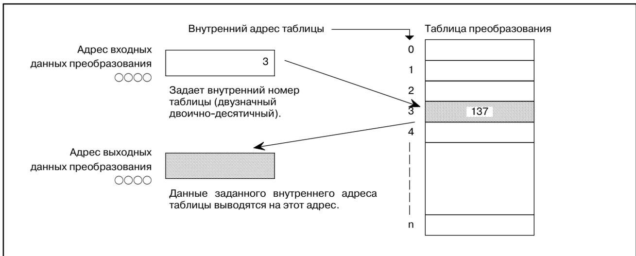
Рис. 5.14.1 Диаграмма преобразования кода
