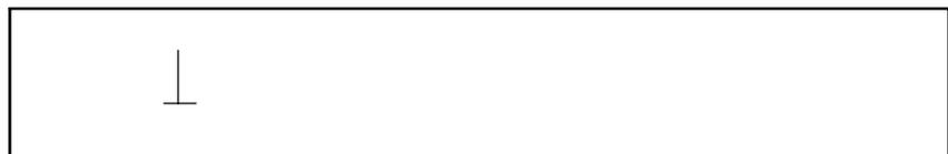
Используйте шаг конца блока, чтобы завершить вызов шага вложенного блока и вернуться в вызывающую последовательность.
