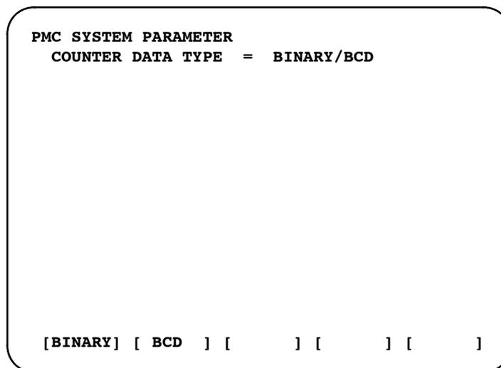
Рис. I.3.2 PMC-PA1 или PA3 Экран системных параметров
