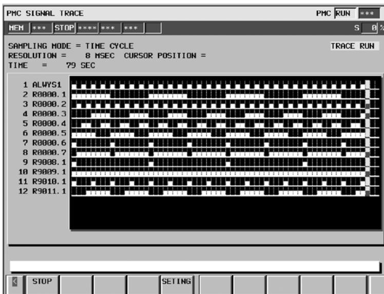
Результат трассировки сразу же отображается во время ее выполнения. Если условие останова, заданное в окне установки параметров, выполняется, то выполнение трассировки завершается. Нажатие дисплейной клавиши [STOP] прерывает выполнение.
