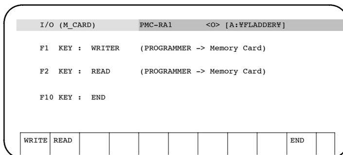
**Рис. К.2.1 (с) Экран ввода/вывода (I/O M\_CARD)**
