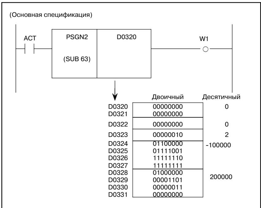
Если АСТ = 1 для вышеуказанной цепной схемы и данных управления, W1 = 1 то:  $-100.000 \leq$  текущее положение (вторая ось) в системе координат станка  $\leq 200.000$  мм
