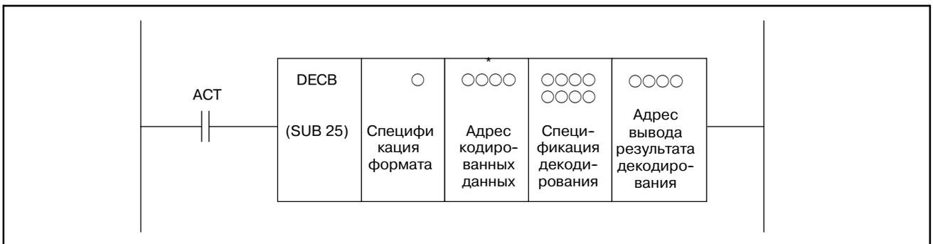
Рис. 5.8.2 (c) Формат выражения DECUB (основная спецификация)
