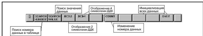
Дисплейные клавиши окна редактора таблицы данных функциональной команды для функциональной команды CODB.
