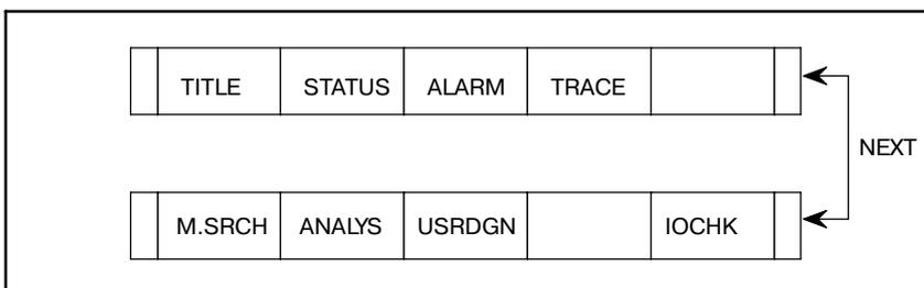
Поддерживается только экран проверки соединения по каналу связи ввода-вывода. Если нажата клавиша [IOCHK], непосредственно отображается экран проверки соединения по каналу связи ввода-вывода.
