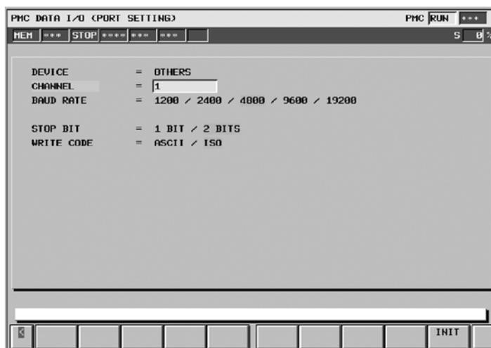
Данное окно позволяет осуществить настройку передачи данных, которая необходима для передачи данных с использованием RS-232C. Передача данных может быть настроена отдельно для каждого из двух типов устройств. Выбранный тип устройства отображается в окне в меню "DEVICE" (УСТРОЙСТВО).
