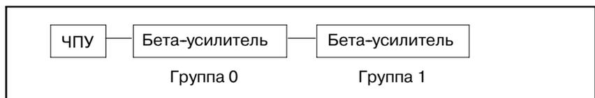
Эти станки могут использовать общую программу последовательности, имеющую данные присвоения каналов связи ввода/вывода, куда входят все конфигурации устройств ввода/вывода. Содержание параметров для каждой конфигурации устройств ввода/вывода приведено на следующей странице.
