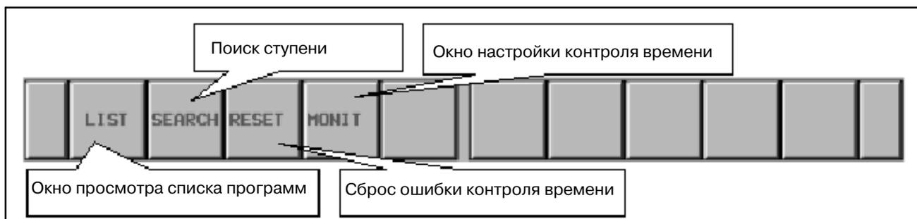
**Рис. 7.2.1.1 Дисплейные клавиши окна состояния последовательности ступеней (полное)**
