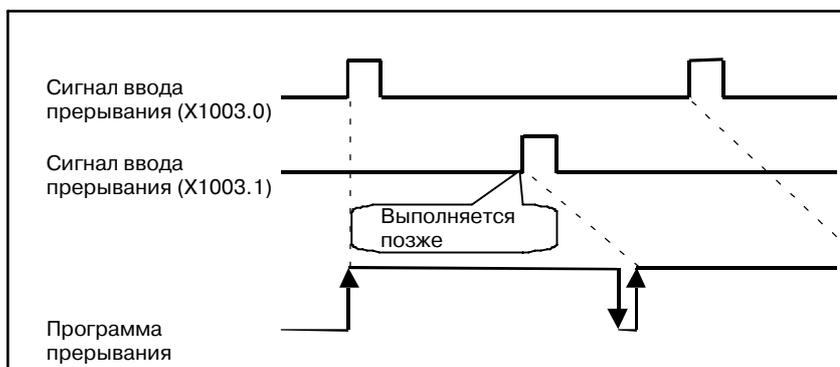
**Рис. 11.3.6 (а) Непрерывные операции прерывания, вызываемые различными сигналами**
